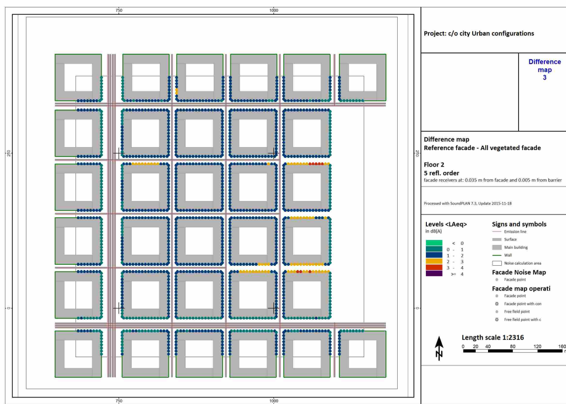
Figur 5. Minskningen i ljudnivå (LAEq,24h), för vegetationsfasad på alla våningsplan (överst: fasadnivåer på plan 1, mitt : fasadnivåer på plan 2, nederst : fasadnivåer på plan 3).
