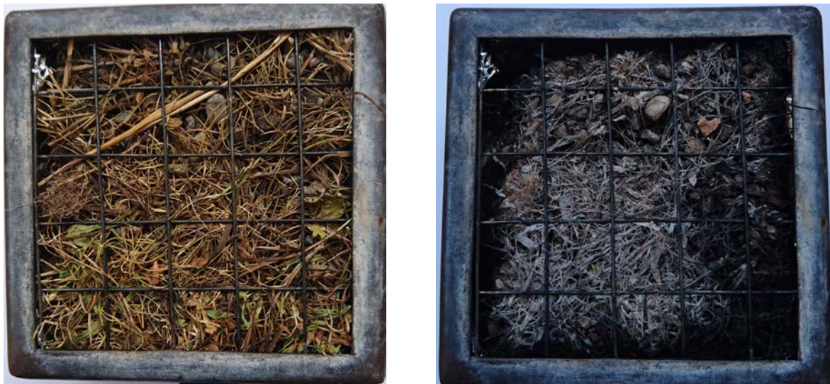
Figur 27. Bild före och efter konkalorimeter testen för konditionerad provkropp.
